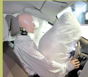
Abb. 23 Crashtest-Dummy mit Airbag
